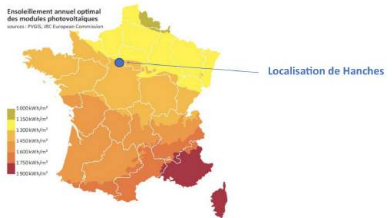
Illustration 49: Localisation du projet par rapport à l'ensoleillement annuel optimal des modules photovoltaïques
